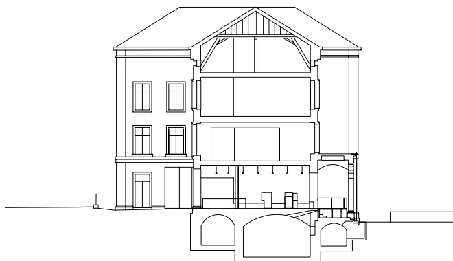
COUPE TRANSVERSALE I LA ZONE DES ARCADES FAIT PARTIE INTÉGRANTE DE L'ESPACE CHAUFFÉ
